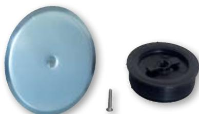
**Tappo ad espansione Ø 100 con piattello in acciaio spessore 7/10 Ø135 mm e vite in acciaio inox 6x30 mm per scatole sifonate plastica e piombo**
