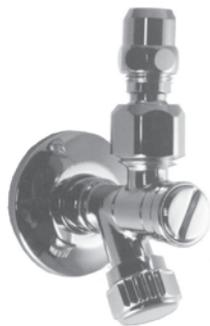
**Rubinetto sottolavabo VA ALBERTONI std con uscita a snodo, filtro in acciaio, con uscita a snodo, filtro in acciaio, movimento a vitone in ottone, zigrinata in ABS, rosone scorrevole cromato, con dado conico basso, vitone hostaform**
