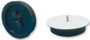
**Tappo ad espansione Ø 120 con piattello in acciaio spessore 7/10 Ø135 mm e vite in acciaio inox 6x30 mm per scatole sifonate plastica e piombo**
