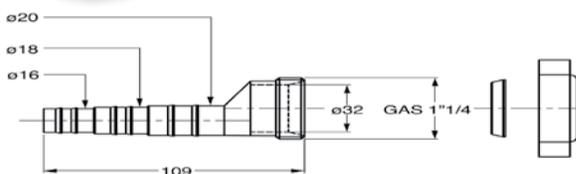
**Raccordo di attacco tubo condensa per collegamento a tubazione di scarico Ø 32 mm**
