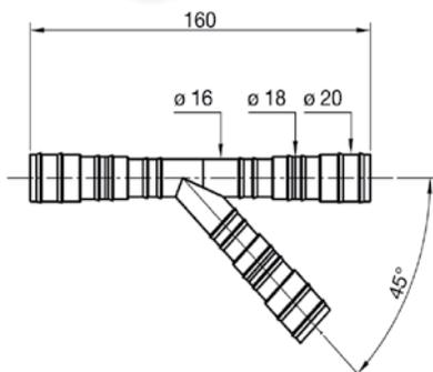
**Braga bianca in PP a "Y" per impianti scarico condensa adatta a tubi Ø 16 - 18 - 20**
