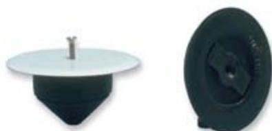
**Tappo ad espansione Ø 80/90 con piattello in acciaio spessore 7/10 Ø135 mm e vite in acciaio inox 6x30 mm per scatole sifonate plastica e piombo**
